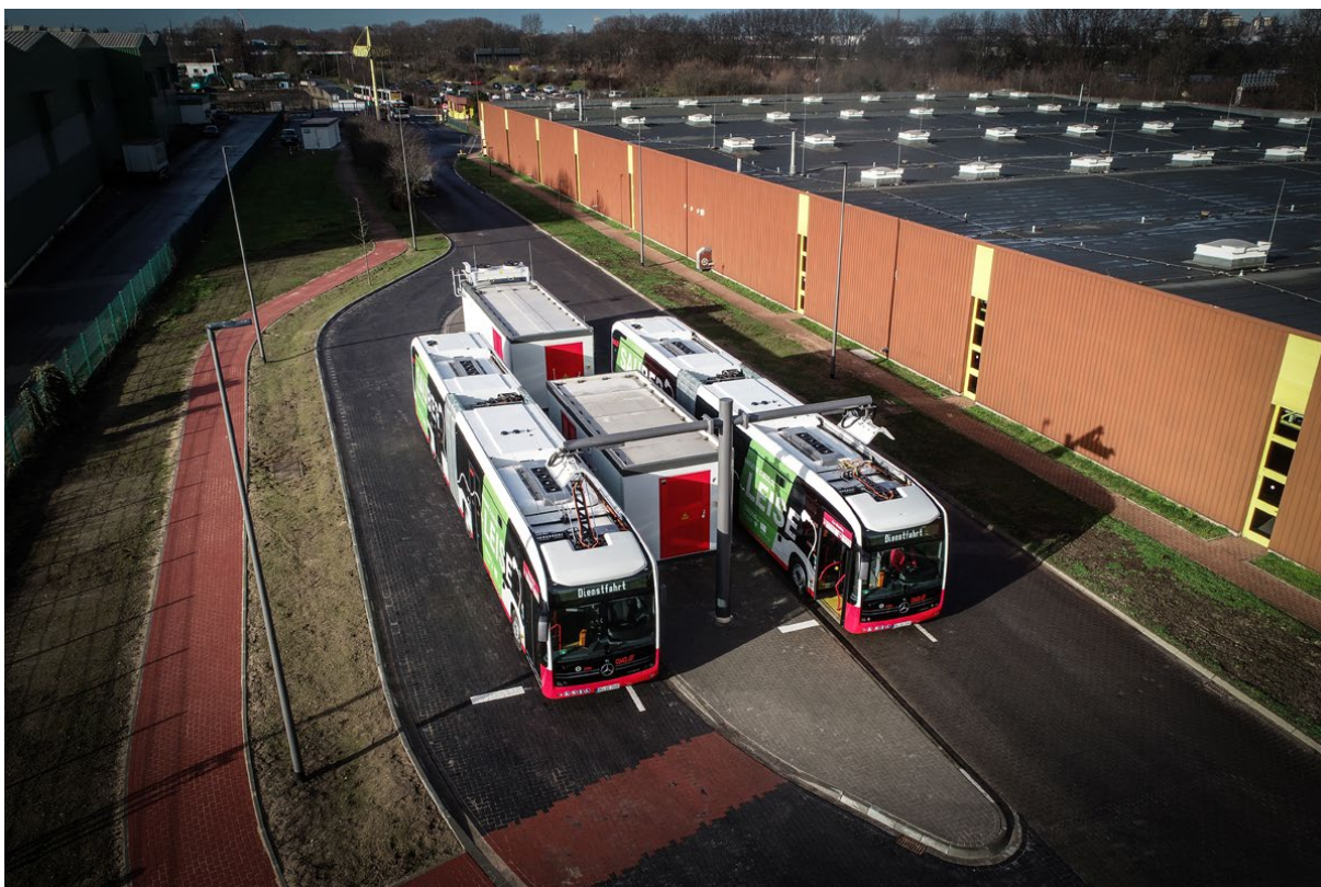
Figure 1 : Charge occasionnelle de deux EvoBus eCitaro G sur les chargeurs rapides de 450 kW [1] (Photo : DVG)
