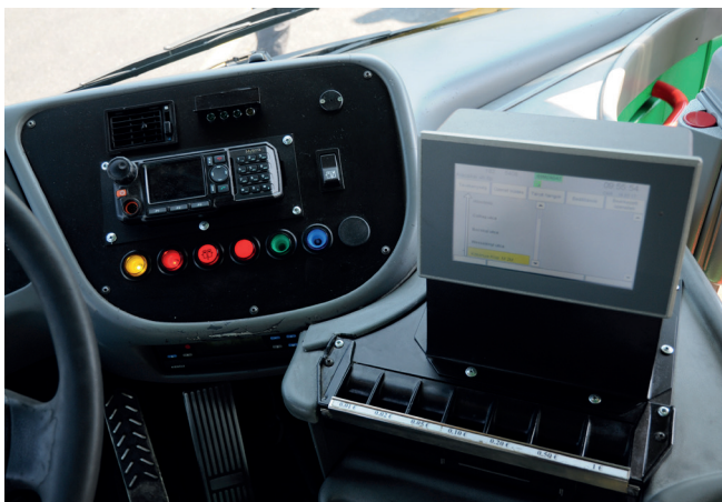
Les ordinateurs de bord modernes informent les conducteurs et contrôlent toute la périphérie des véhicules.
